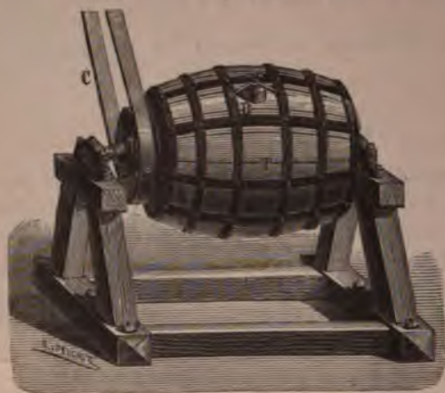
Fig. 255. — Tonne d'amalgamation (méthode saxonne).
